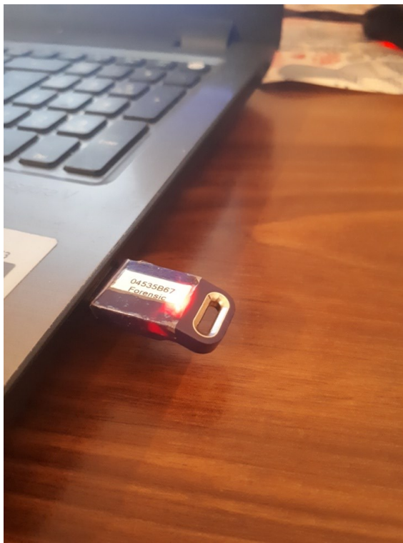
Obr. 21 - Vzorové připojení USB HASP klíče [Zdroj: autor]
