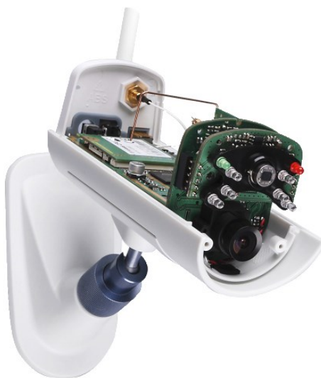
Obr. 16 Kamera EYE-02 – odkrytovaná [42], upravil Macho, 2018
