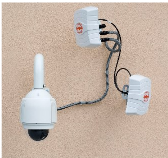
Obr. 15 Řešení Camibox – Kamera, Slave + Client jednotka [41]
