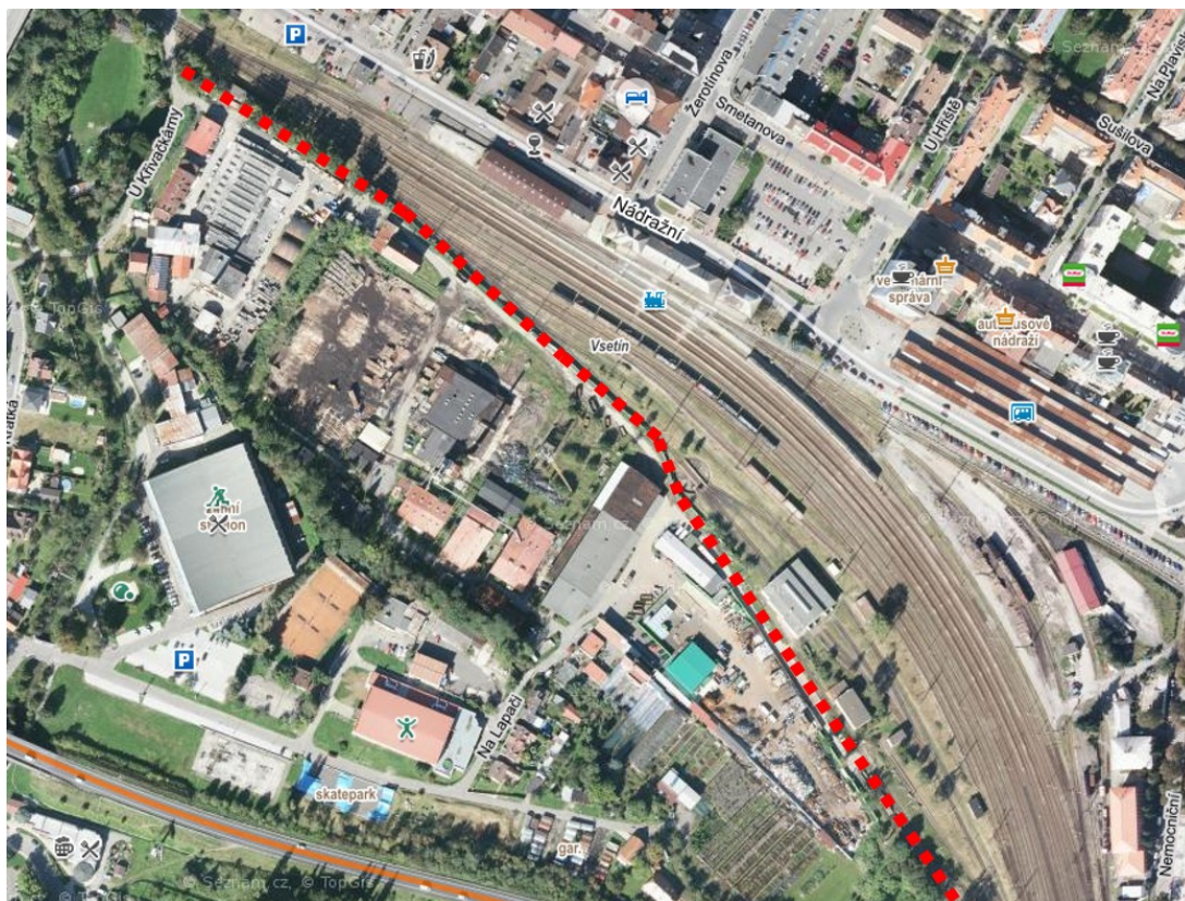
Obr. 25 - Navržené oplocení železniční stanice Vsetín [42, úprava autor]
