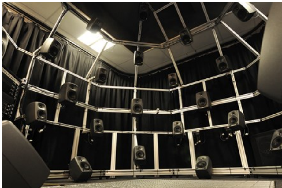
Obrázek 13 - Ukázka 3D reproduktorového pole s 50 kanály nacházejícího se na University of York ve Velké Británii
