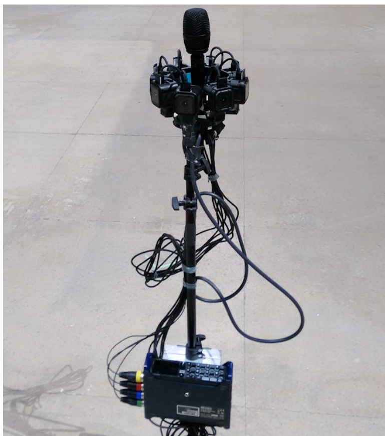
Obrázek 14 - Ukázka umístění mikrofonu, rekordéru a kamer na jeden stativ od prof. Fariny
