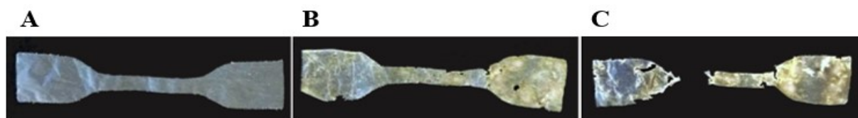
Obrázek 4.2: Fotografie lopatek vyražených z filmu kopolyesteru se škrobem. A-na začátku experimentu; B-po 20 dnech; C-po 70 dnech inkubace v půdě (hnědozem) při 25 °C.
