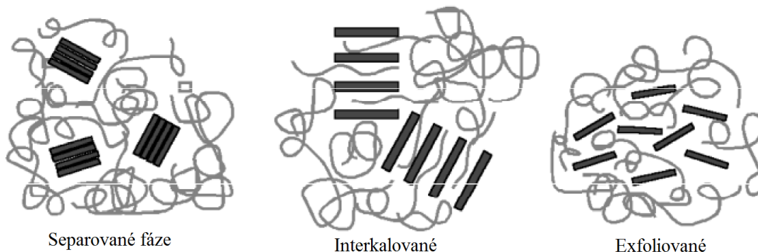
Obr. 1.5 Schematické znázornění různých hybridních struktur směsí polymer/silikát (Giannelis et al. , 1999).
