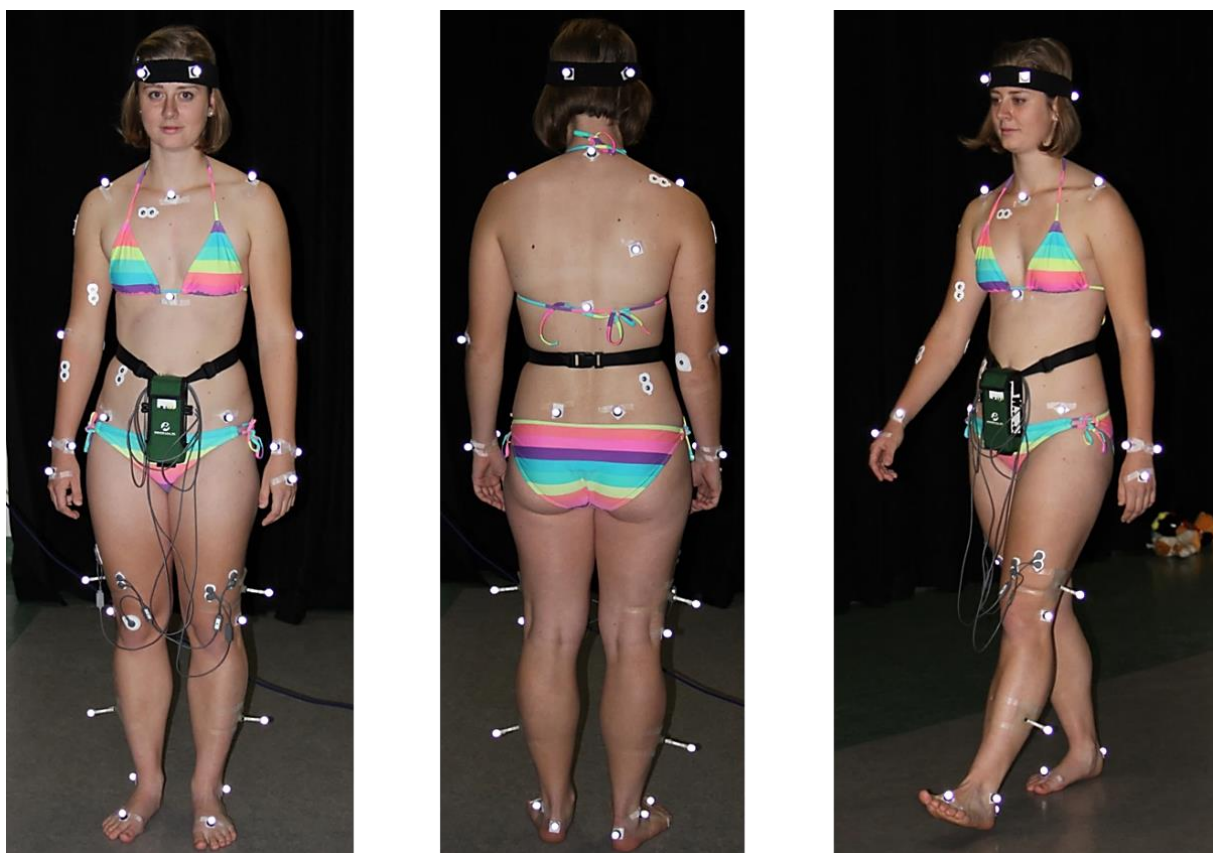
Obr. 9 Příklad umístění retro-reflexních markerů (a EMG sond) na těle probanda
