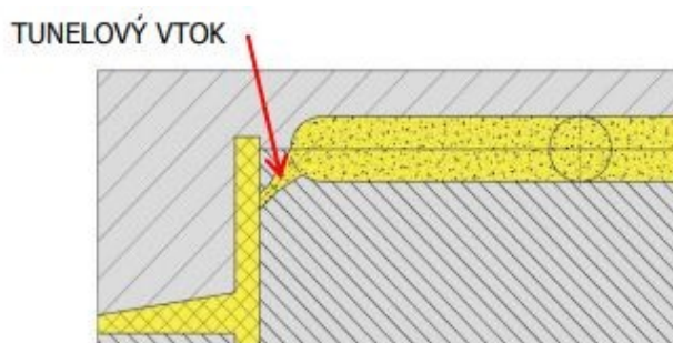
Obr. 8 Tunelový vtok v řezu [13]
