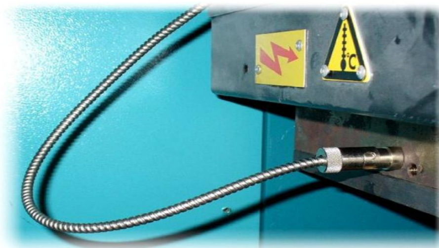
Obr. 40 Umístění teplotního čidla na vstřikovacím stroji
