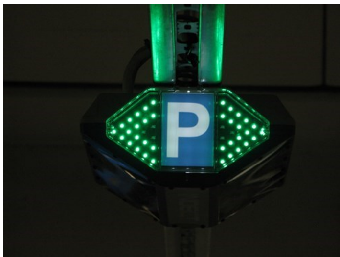
Obr. 12: Senzor upsolut ukazující směr volného parkovacího místa [27]
