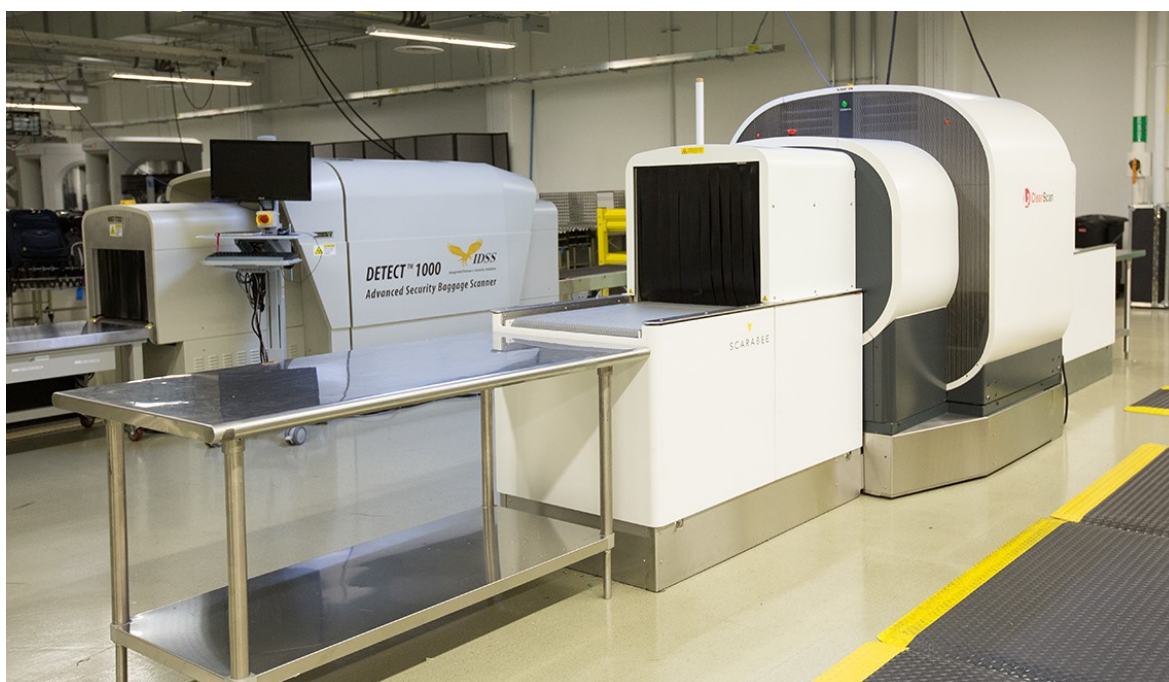
Obrázek 9: 3D zavazadlový rentgen [10]
