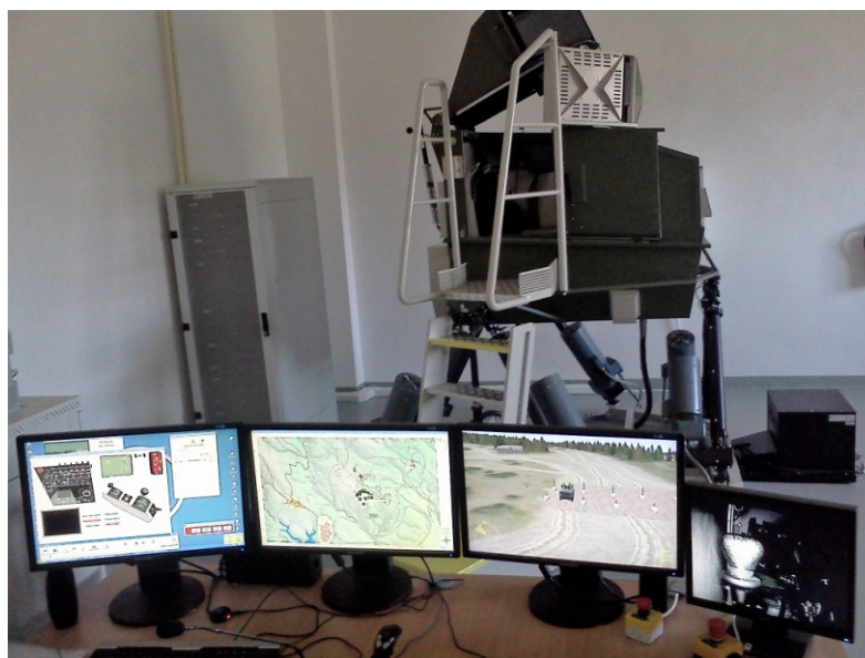
Obr. 10: Řidičský trenažér vozidla PANDUR II.
