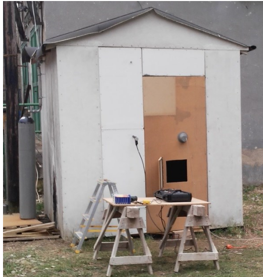
Obr. 43 Chráněný prostor připraven na zkoušku s vypuštěním hasiva [Vlastní]
