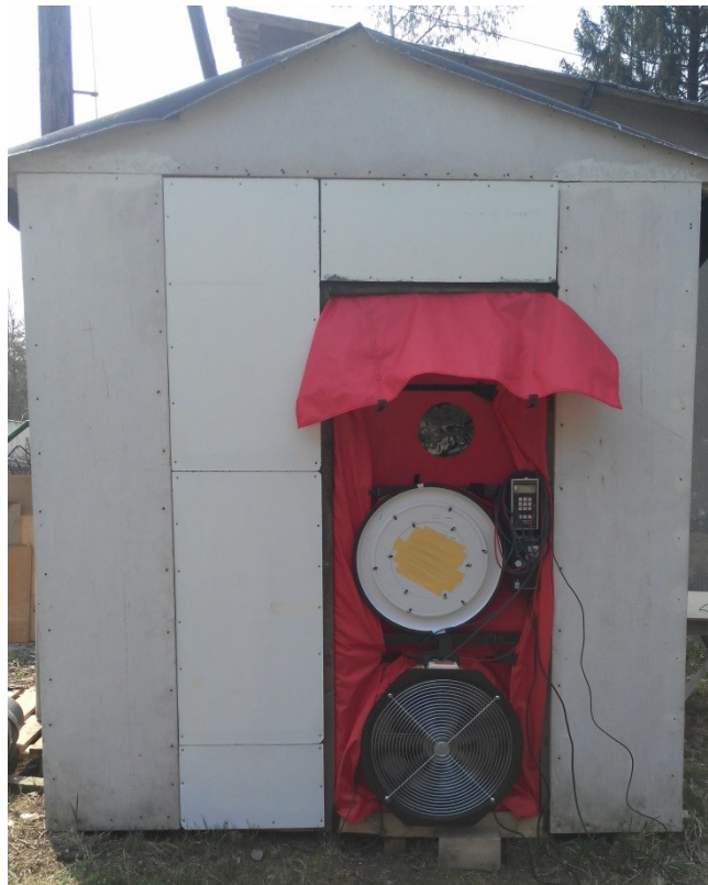
Obr. 52 Měření při podtlaku v chráněném prostoru [Vlastní]
