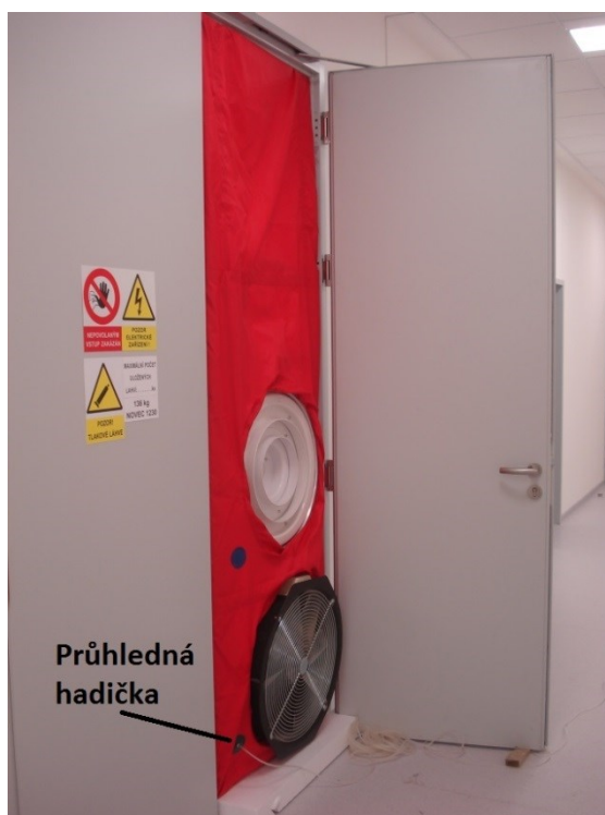
Obr. 16 Průhledná hadička zapojená v průchodce plachty [1]
