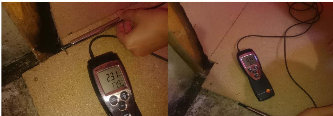
Obr. 25 Vlevo je zobrazena netěsnost mezi ohořelým místem a přidanou deskou a vpravo je zobrazena netěsnost mezi podlahou a deskou zakrývajícím ohořelé místo [Vlastní]
