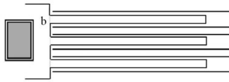
Obr. 6 Hlavové uspořádání výpravní budovy [8]
