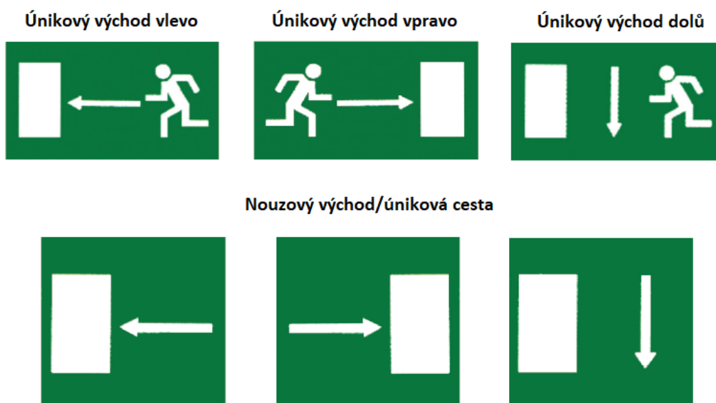
Obr. 10 Informativní značky pro označení únikové cesty a nouzového východu [43]
