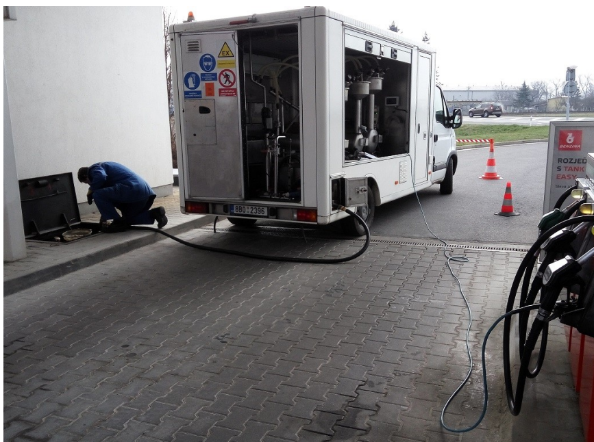
Obr. 22. Uzemnění EMS při stáčení [19]
