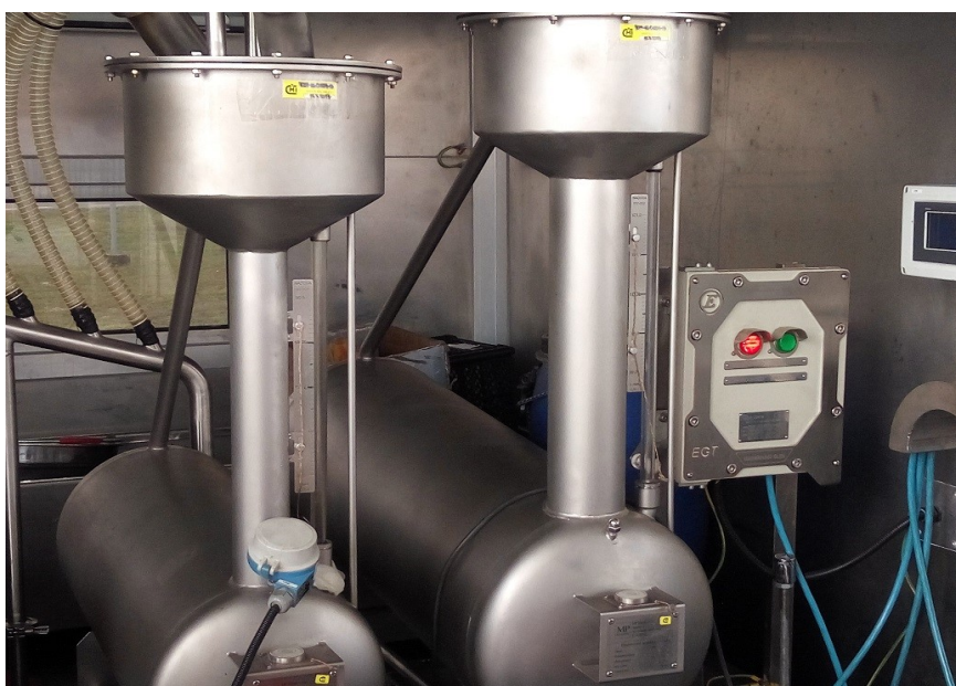
Obr. 20. Odzemnění EMS – indikace zemnicího členu [19]
