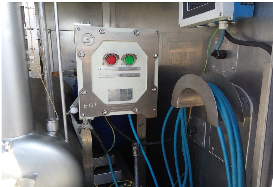
Obr. 12. Detail zemnicího členu EMS [19]
