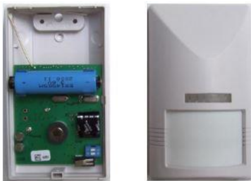
Obr. 10. Rádiový detektor Octopus [22]
