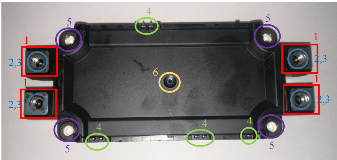
Obr. 23 Produkt2 kontrolované časti – pohľad z vrchu
