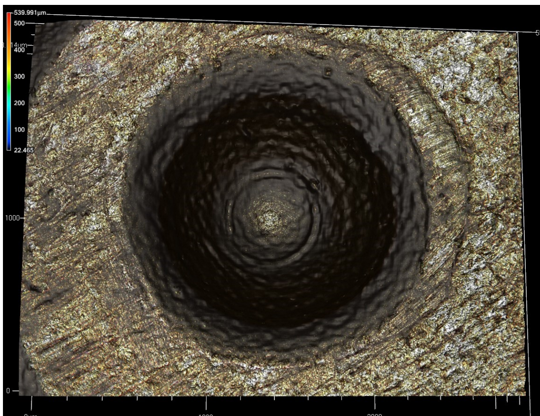
Obr. 17. Stopa po zápalníku na zápalce nábojky č. 4.
