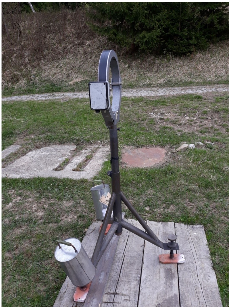
Obr. 43. Elektromagnetická cívka se stojanem.
