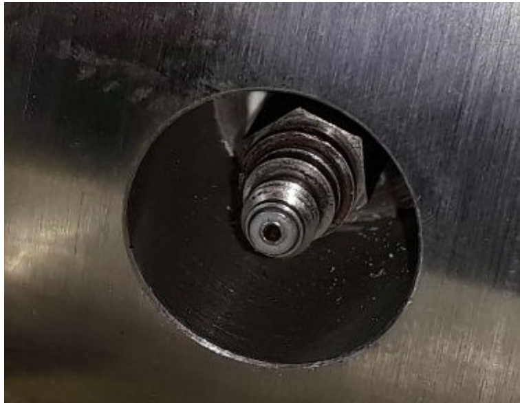
Obr. 42. Instalovaný piezoelektrický tlakoměr.
