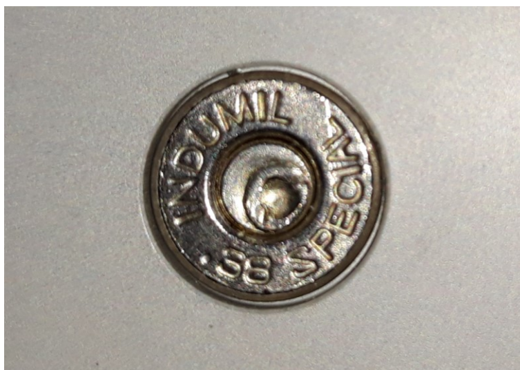
Obr. 10. Stopy na zápalce a dnu nábojnice.
