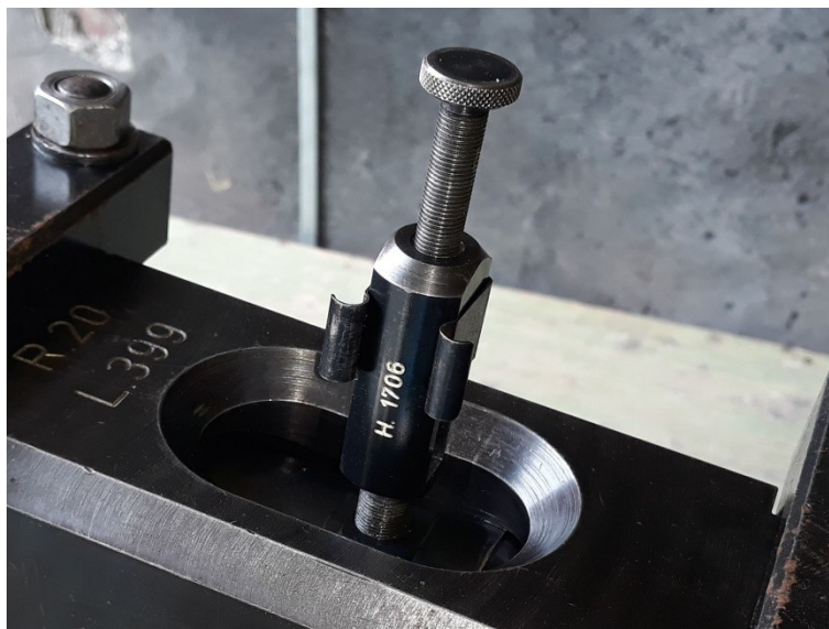
Obr. 41. Instalovaný mechanický tlakoměr.
