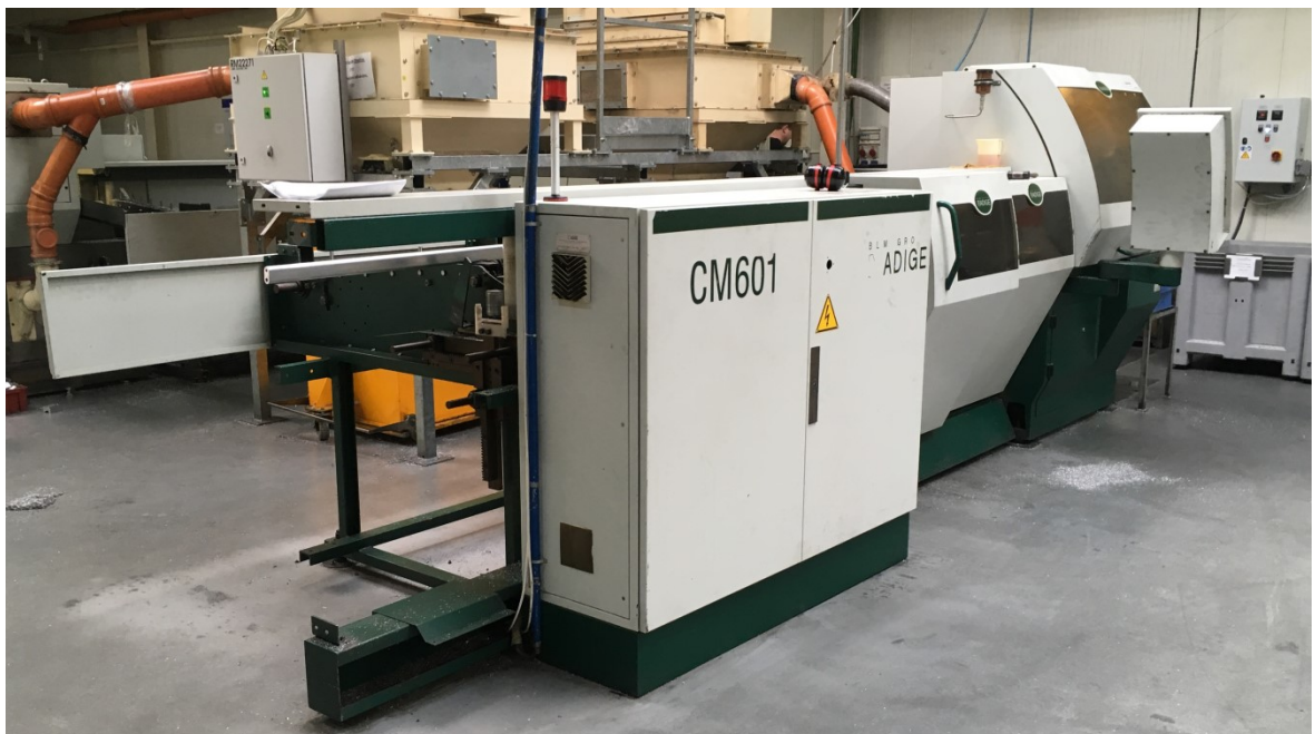
Obrázek 17: Kotoučová pila CM601 od firmy Adige (vlastní zpracování)
