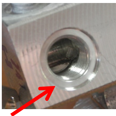
Obrázek 30: Výrobek s vadou - otvor mimo toleranci (vlastní zpracování)
