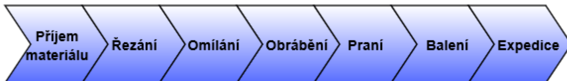
Obrázek 15: Tok materiálu výrobním procesem (vlastní zpracování)
