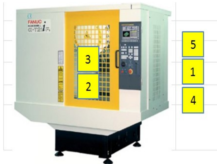
Obrázek 31: Frézovací stroj typu Robodrill s vyznačenými zónami údržby (vlastní zpracování)
