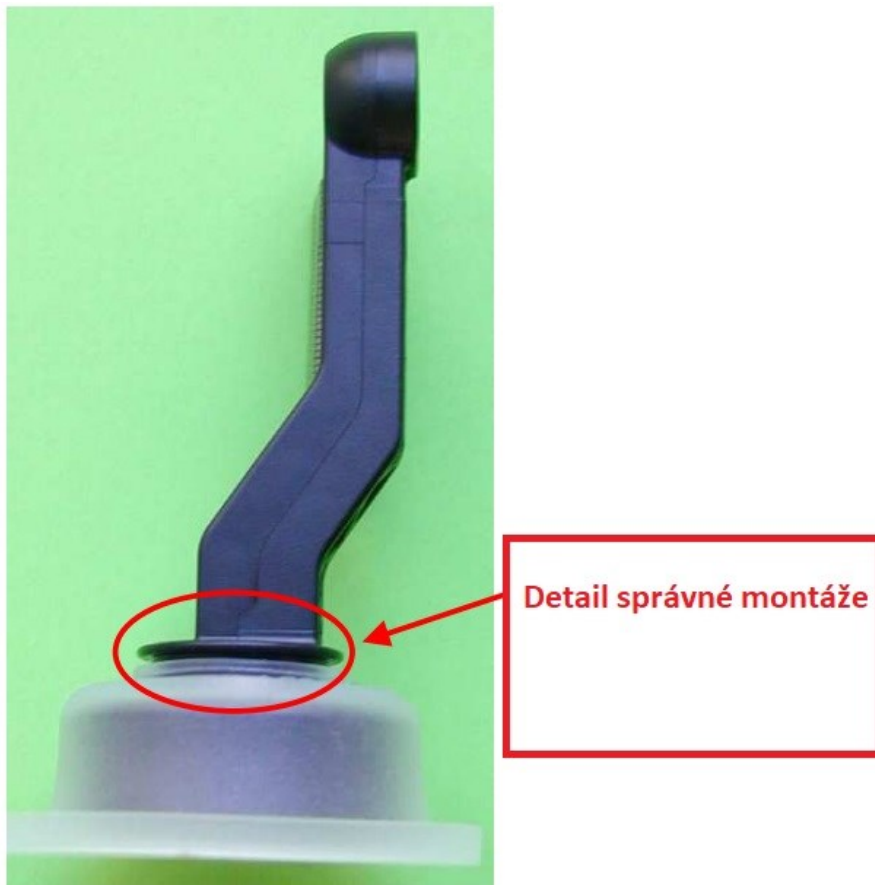
Obr. 21 Detail správné montáže membrány (interní materiál)
