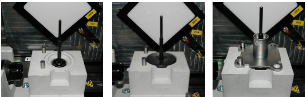
Obrázek 17 - Postupné vkládání dílů při montáži tyčky (vlastní zpracování)
