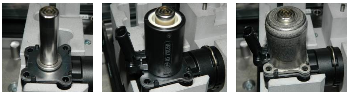
Obrázek 21 - Příprava ventilu na sešroubování (vlastní zpracování)
