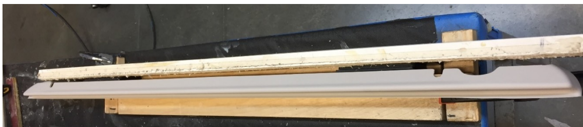
Obrázek 77 Vložení dílu 4B do lepicího přípravku (vlastní zpracování)
