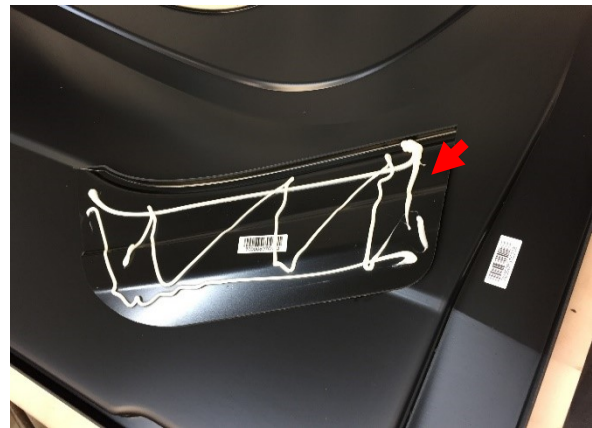
Obrázek 25 Nanesení lepidla na díl 1C (vlastní zpracování)
