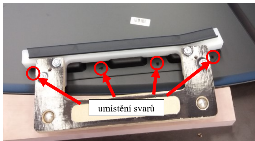
Obrázek 59 Sváry na dílu 3C (vlastní zpracování)
