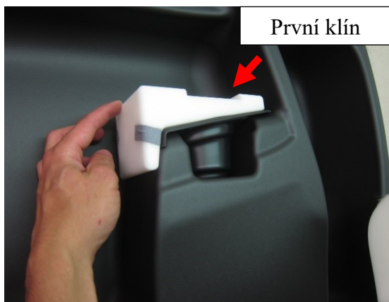
Obrázek 29 Vložení dílu 1A do dílu 1D (vlastní zpracování)
