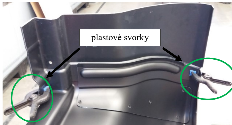
Obrázek 53 Připnutí pomocného přípravku (vlastní zpracování)
