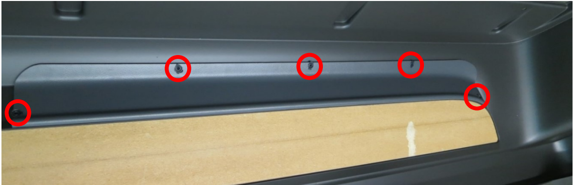
Obrázek 45 Vložení dílu 2C a svaření (vlastní zpracování)
