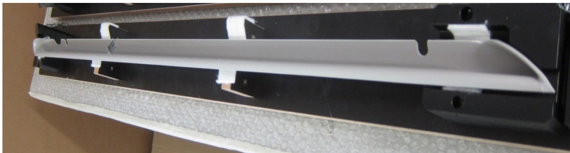
Obrázek 68 Vložení dílu 4BA do lepicího přípravku (vlastní zpracování)
