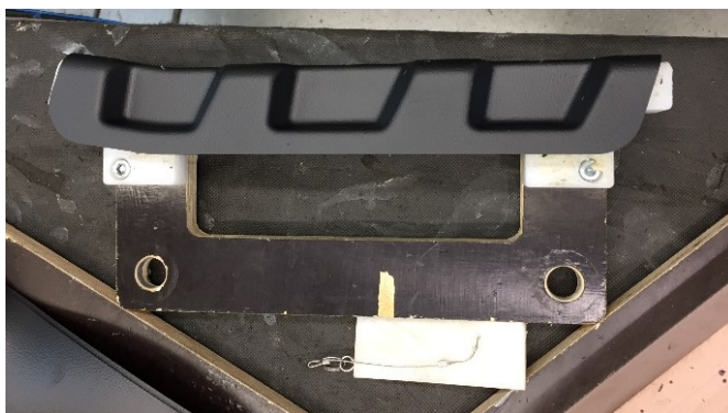
Obrázek 55 Vložení dílu 3C do lepicího přípravku (vlastní zpracování)
