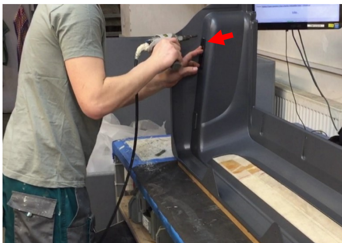
Obrázek 40 Svaření dílu 2B (vlastní zpracování)
