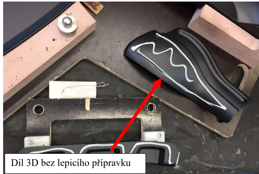
Obrázek 90 Díl 3D bez lepicího přípravku (vlastní zpracování)
