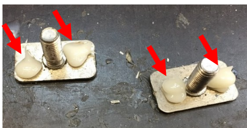
Obrázek 79 Nanesení lepidla na piny (vlastní zpracování)
