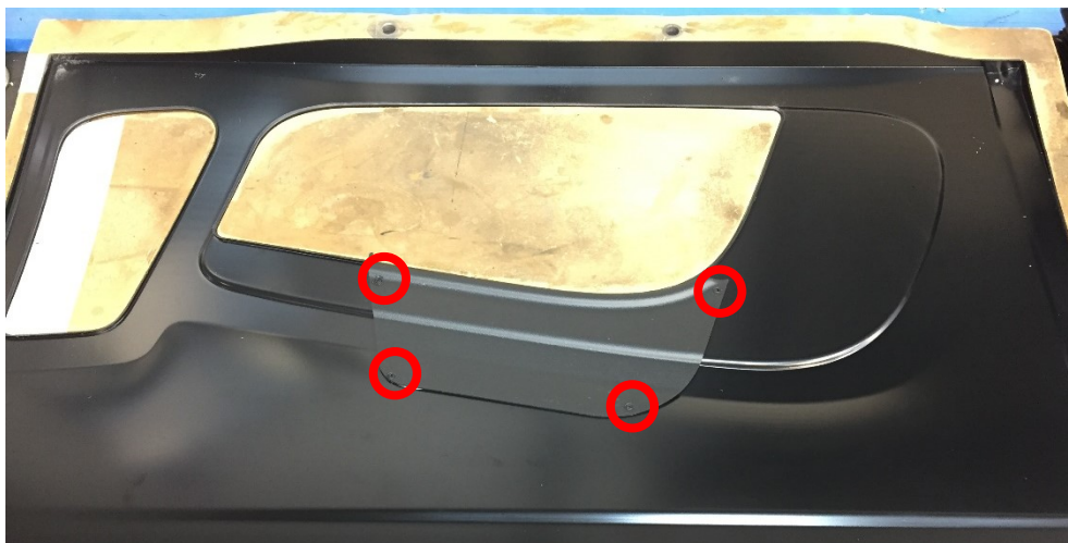
Obrázek 27 Svaření dílu 1Ba 1C (vlastní zpracování)
