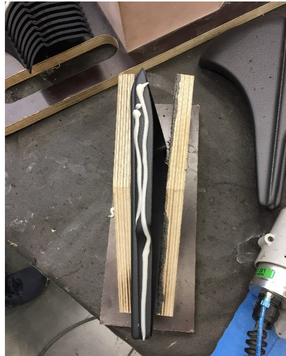
Obrázek 57 Nanesení lepidla na díl 3B (vlastní zpracování)
