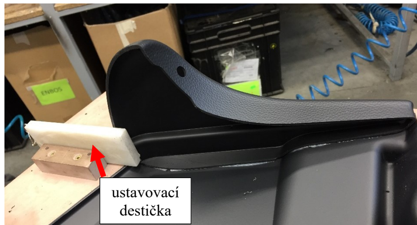
Obrázek 60 Vložení dílu 3B do dílu 3A (vlastní zpracování)
