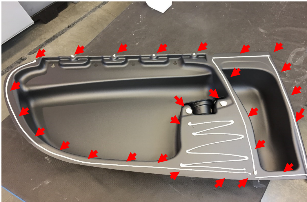
Obrázek 31 Nanesení lepidla na díl 1A (vlastní zpracování)
