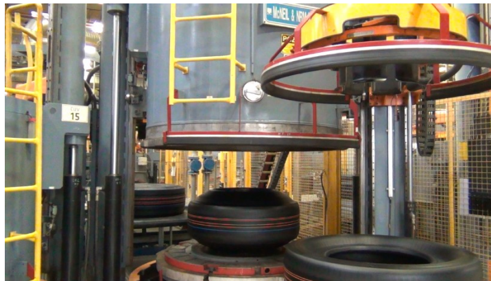
Obrázok 20 Zatváranie lisu (vlastné spracovanie)
