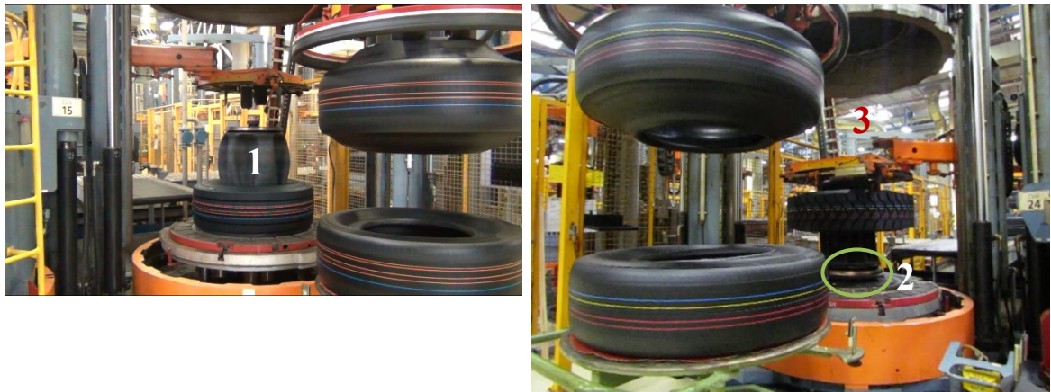
Obrázok 17 Fáza pohybu vykladača a membrány (vlastné spracovanie)
