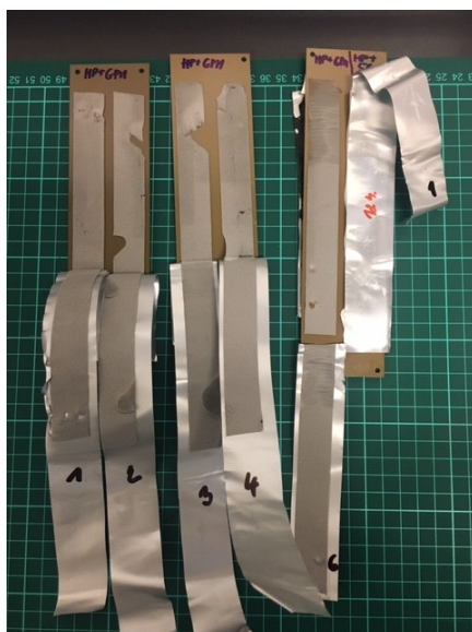
Obr. 96 Kohezní porucha v pásce GPH na lakovaném plechu
