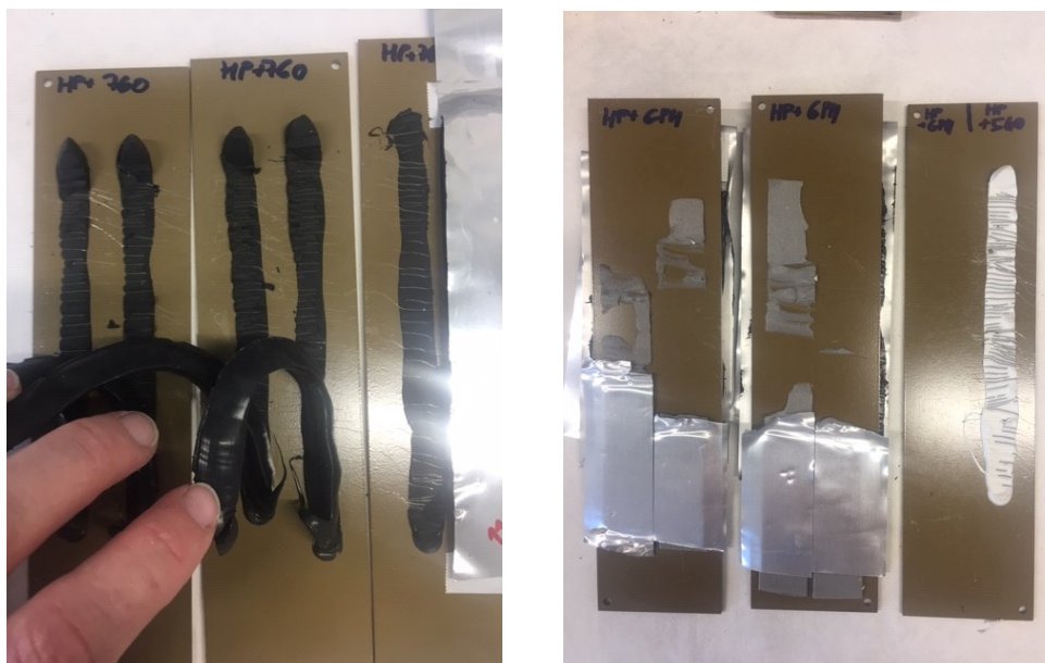
Obr. 79 + 80 Adhezni testy lepidla 760, pásky GPH160 a lepidla 560
