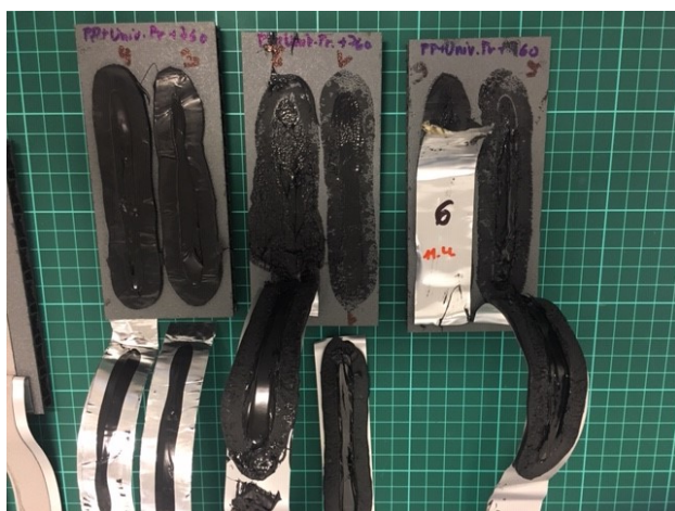
Obr. 94 Porucha spoje lepidla 760 na PP desce
