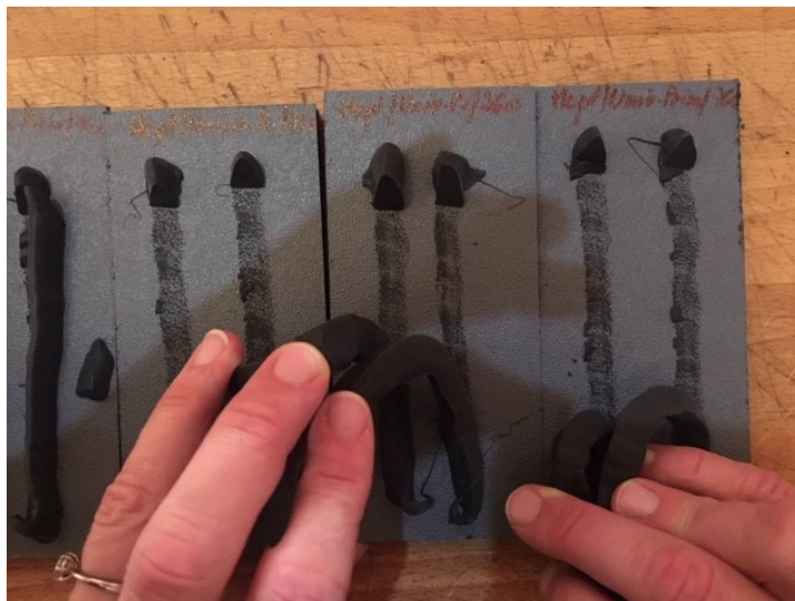
Obr. 89 Kohezní selhání lepidla blízko rozhraní lepidlo/substrát při použití Universal Primeru
