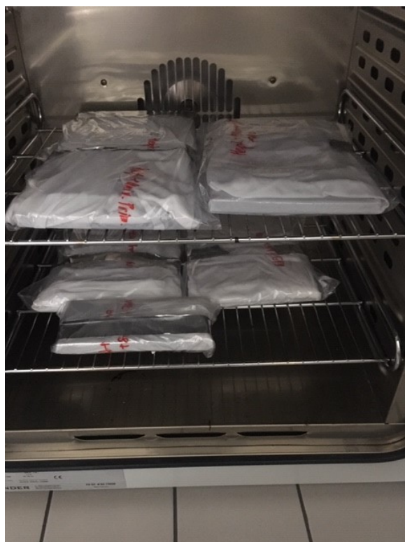
Obr. 74 Vzorky pro klimatické zatížení tzv. Kataplazmou ve stadiu zahřívání v peci na 70°C
