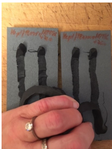
Obr. 87 Kohezní porucha u lepidla a AP596 Obr. 88 Kohezní porucha u lepidla a Sika 100
