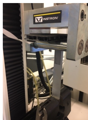
Obr. 95 Trhací zařízení s válečkem pro 90° odlup
