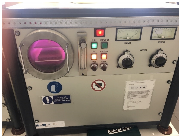
Obr. 63 Generátor nízkotlakého plazmatu používán pro tuto práci
