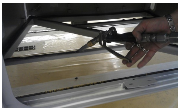
Obr. 61 + 62 Současná aplikace lepidla 3M 560 na rám autobusu a zatížení lepeného panelu
