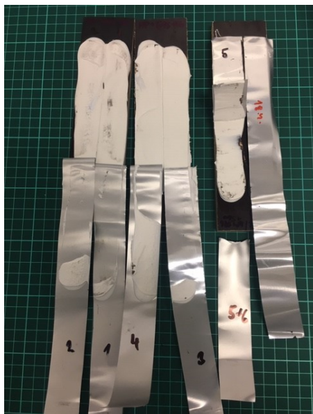
Obr. 92 Typ poruchy u lepidla 560 na překližce
