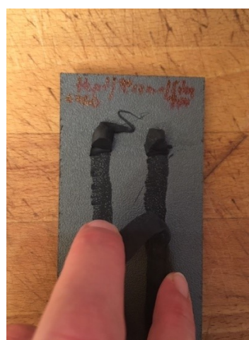
Obr. 87 Kohezní porucha u lepidla a AP596 Obr. 88 Kohezní porucha u lepidla a Sika 100
