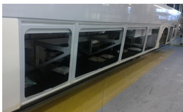
Obr. 61 + 62 Současná aplikace lepidla 3M 560 na rám autobusu a zatížení lepeného panelu
