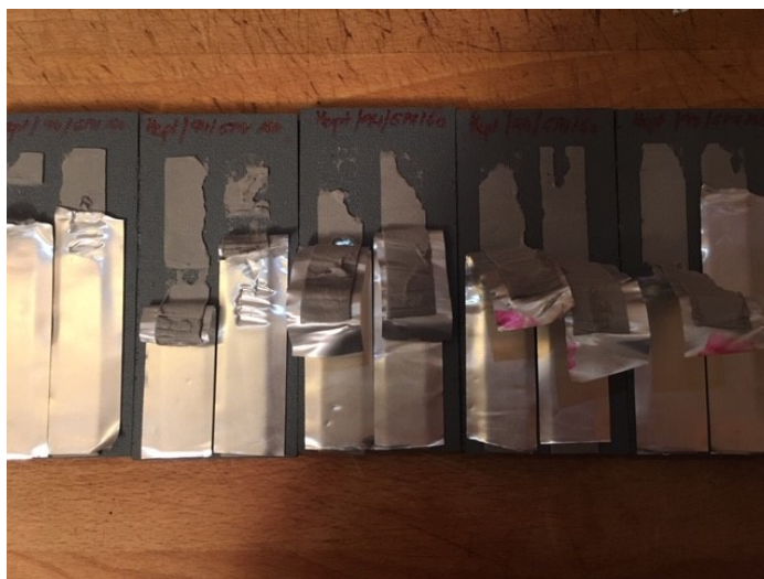
Obr. 91 Kohezní porucha pásky GPH 160 po kataplazmě
