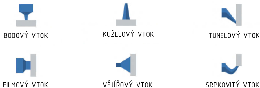
Obr. 23 Základní typy vtokových ústí [16]
