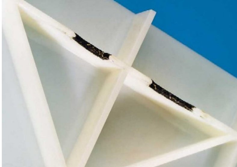
Obr. 18 Dieselekt způsobený nedostatečným odvzdušněním formy [15]
