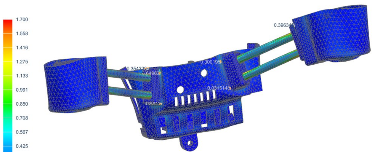
Obr. 55 Napětí v rizikových místech koptéry při působení gravitace
