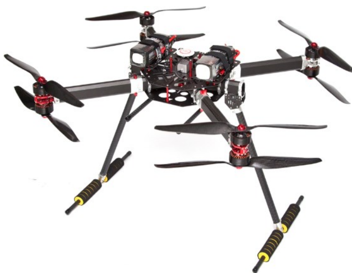
Obr. 3 Konstrukční řešení dronu nesoucí označení „koaxial X8“ [4]
