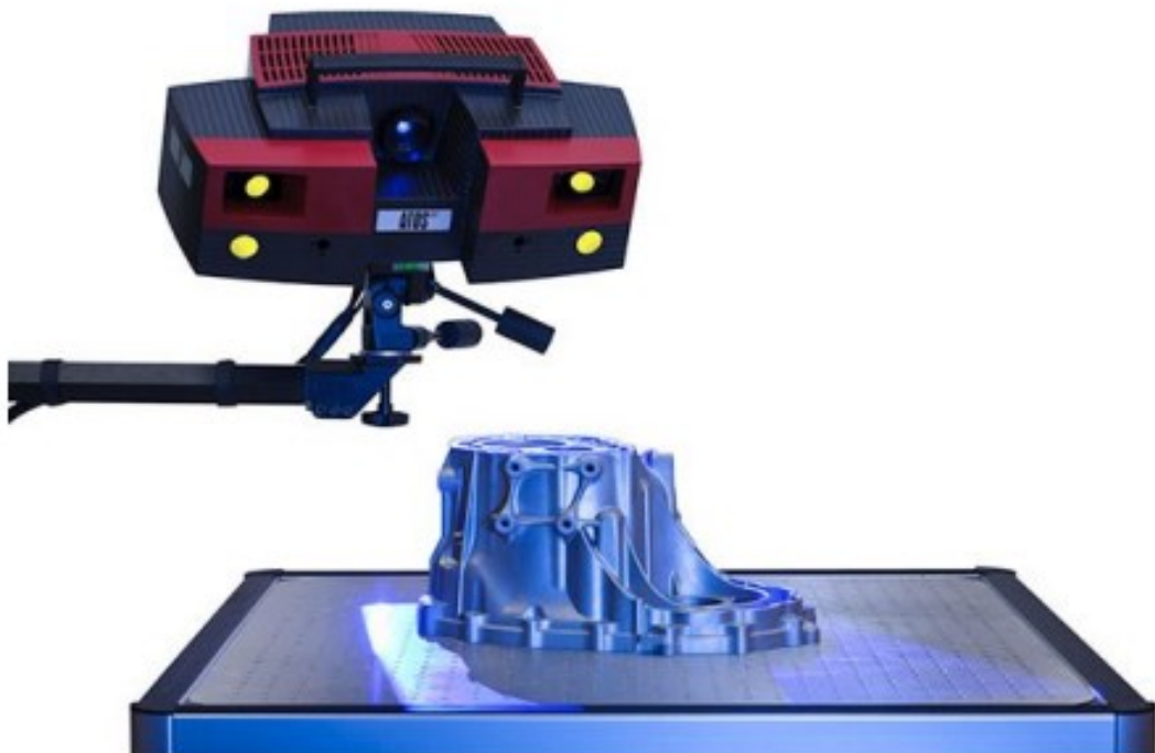
Obr. 8 Princip optického skenování skenerem Atos [22]
