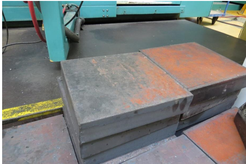
Obr. 1922 Vypálené polotovary pro desky
