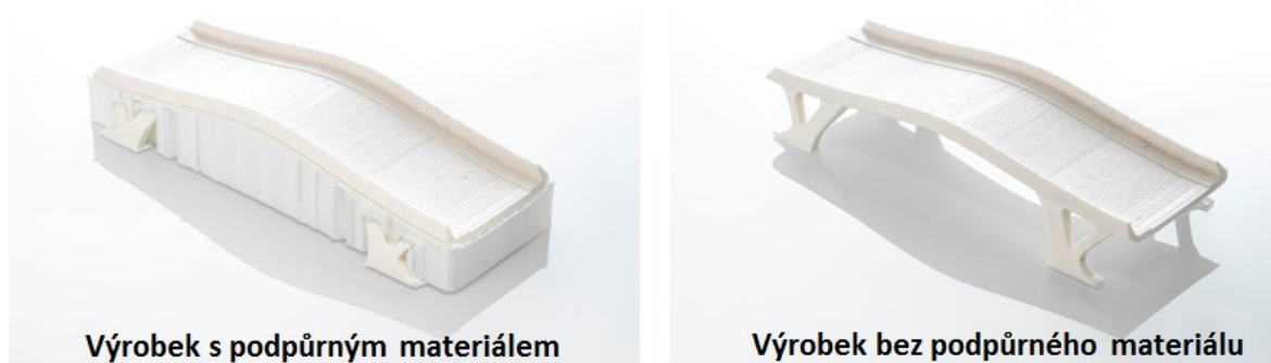
Obr. 28: Výrobek s podpurným materiálem a bez podpurného materiálu [36]
