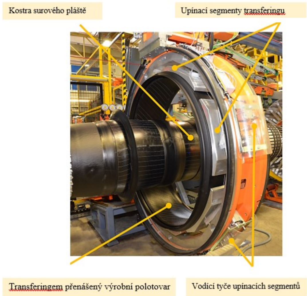
Obr. č.9 Konfekční stroj na nákladní radiální pláště (T-Ring)
