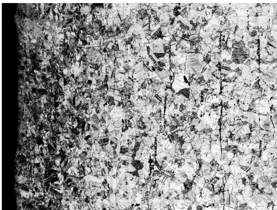
Obr. 102: Struktura materiálu 17 240; zvětšení 150x
