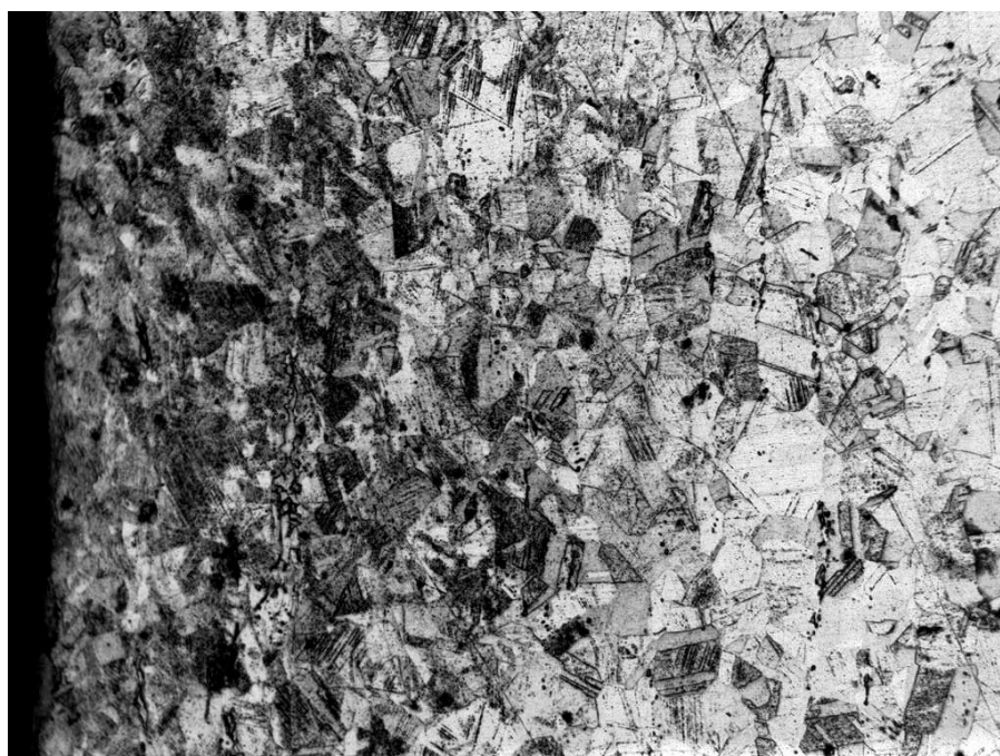
Obr. 103: Struktura materiálu 17 240; zvětšení 300x
