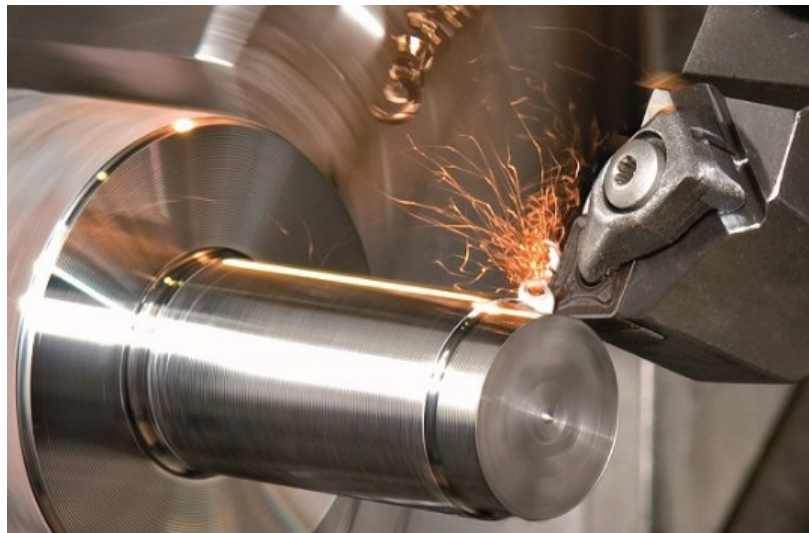
Obr. 15. Konvenční metoda obrábění - soustružení
