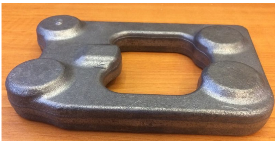
Obr. 13. Výkovek po ostřížení a děrování
