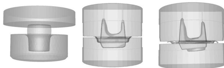
Obr. 9. Schéma zápustkového kování
