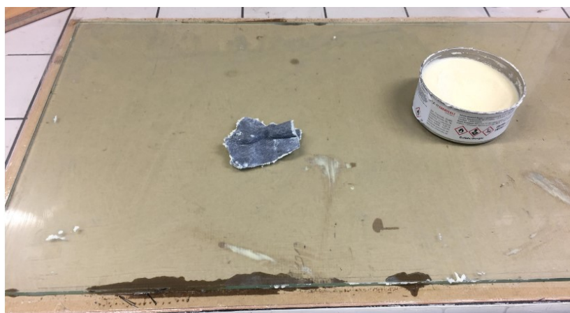
Obrázek 30 Nanášení vosku na formu
