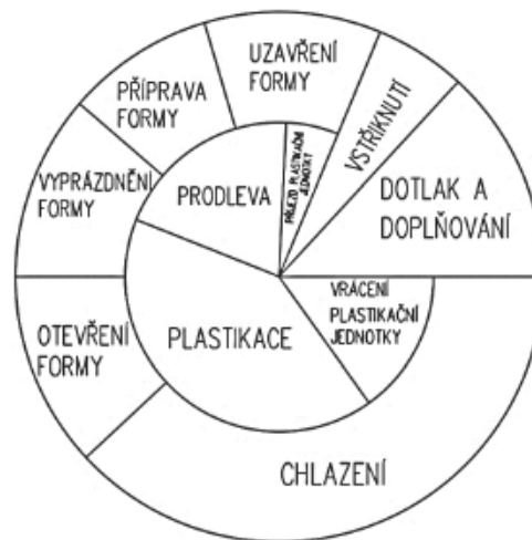
Obr. 9 Postup kroků vstřikování u plastikační jednotky (vnitřní prsteneček) a formy (vnější prsteneček) [86]
