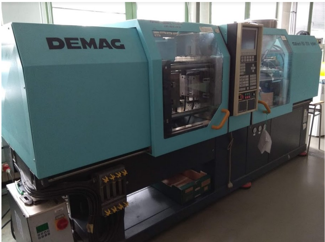
Obr. 24 Vstřikovací stroj DEMAG
