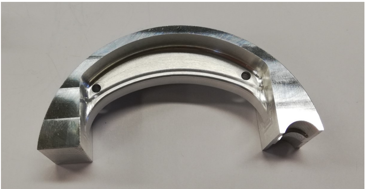
Obr. 59. Čelist po odstranění držáku a zabroušení
