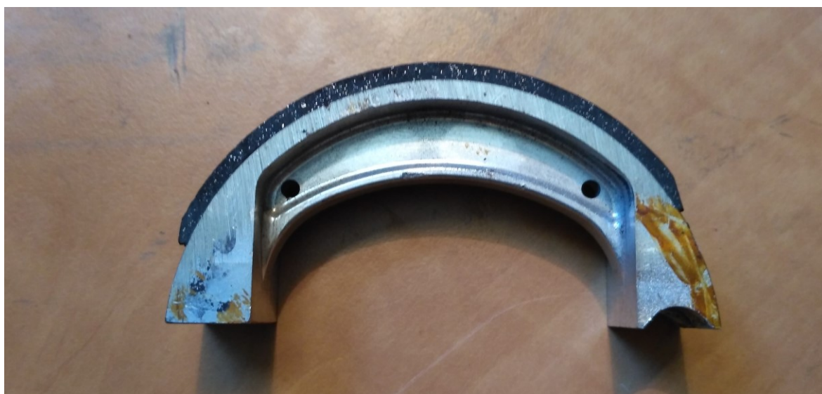
Obr. 68. Vyrobené čelisti s brzdovým obložením
