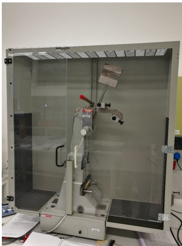
Obr. 18. Měřicí zařízení Izod Pendulum Impact Tester 2.75 J
