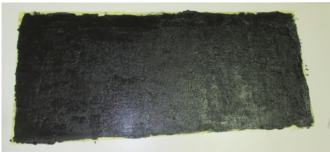
Obr. 12 Aramidová tkanina potřená nánosovým roztokem
