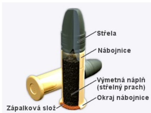
Obr. 6 Řez malorážkovým kulovým nábojem .22 LR s okrajovým zápalom [13]
