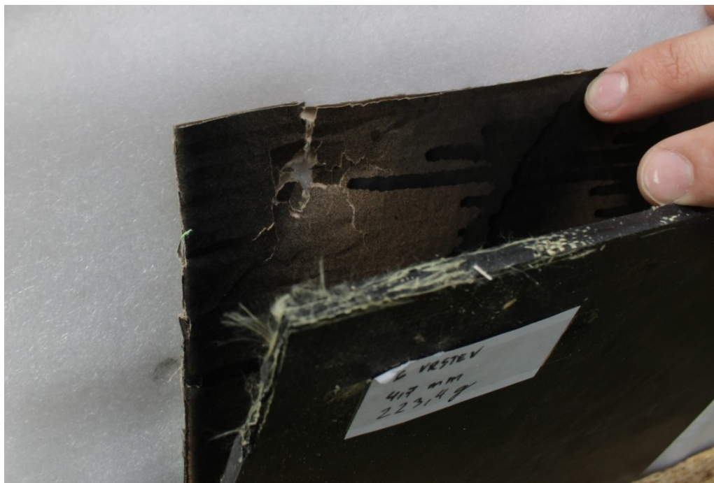
Obr. 24 Vtisk po průstřelu vzorku číslo 1 ráží 9 mm Luger
