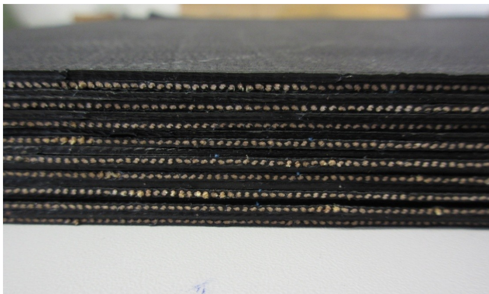
Obr. 15 Kompozit z materiálu průmyslové výroby před vulkanizací
