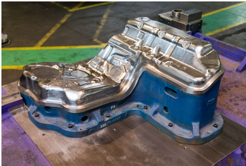
Obr. 15. Hydromechanicky vyrobená část palivové nádrže automobilu [30]
