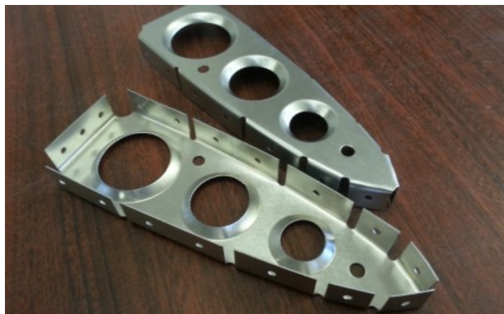
Obr. 4. Vylisek technologie Guerin – příčná výztuha křídla letounu [21]
