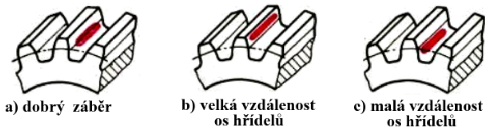
Obr. 11: Kontrola záběru ozubených kol pomocí barvy [4]
