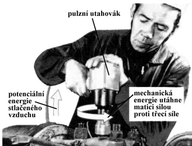
Obr. 30: Přeměna energie pulzního utahováku [13]
