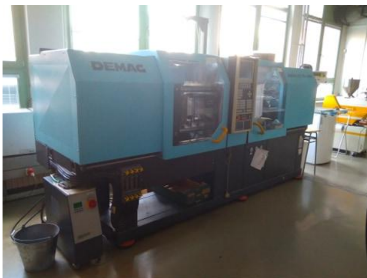
Obr. 13 Vstřikovací stroj DEMAG ERGOtech 50-200 system
