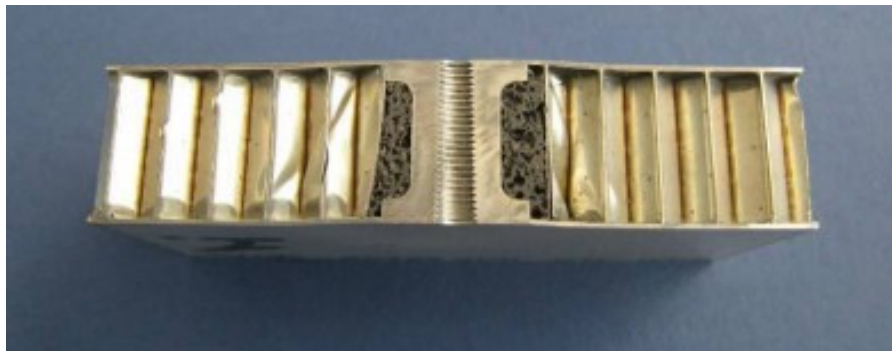
Obr. 16 Řez sendviče s insertem „Hot bonded“ [15]
