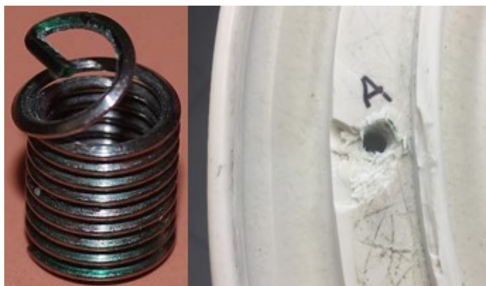
Obr. 54 Insert typu A po vytržení z desky
