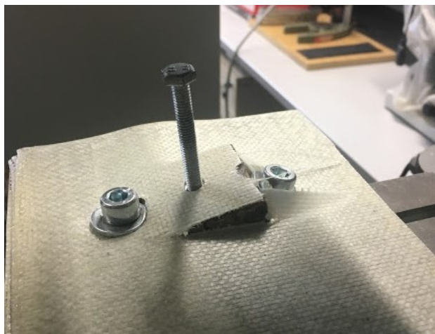
Obr. 81 Detail pro vytržený insert M6 v kartitu z prepregu
