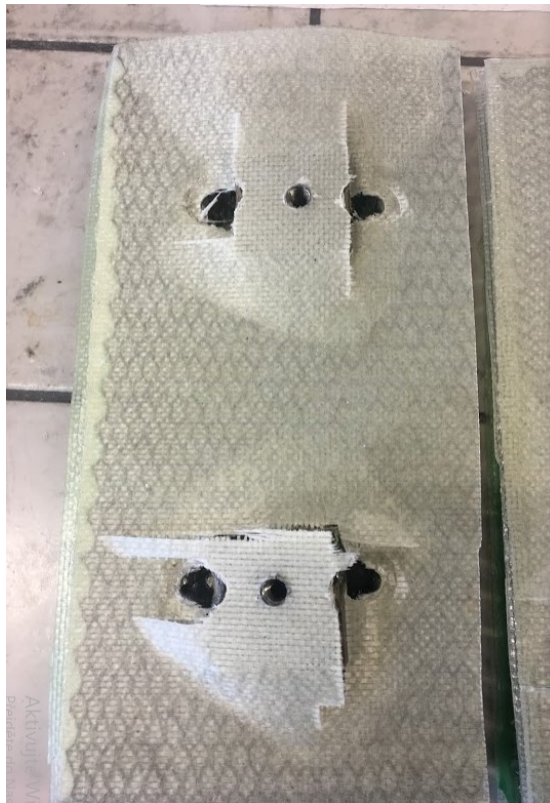
Obr. 64 Kartitové tělesa po tahové zkoušce
