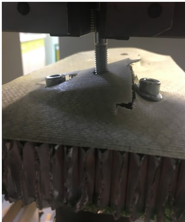
Obr. 63 Ukázka průběhu zkoušky pro vzorky s kartitem
