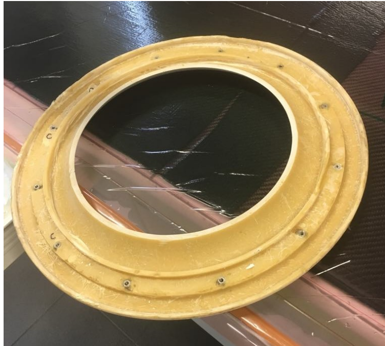
Obr. 24 Zkušební záchodová deska obsahující zalaminované inserty
