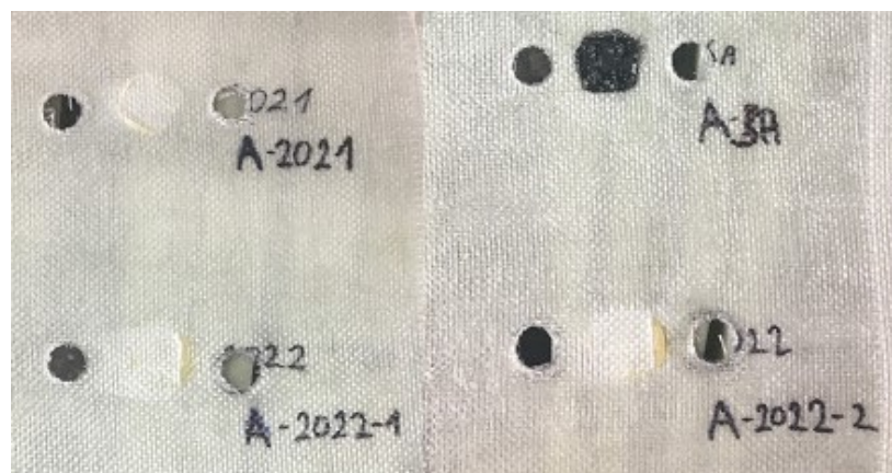
Obr. 56 Podkladová deska 1 po odtržení insertů
