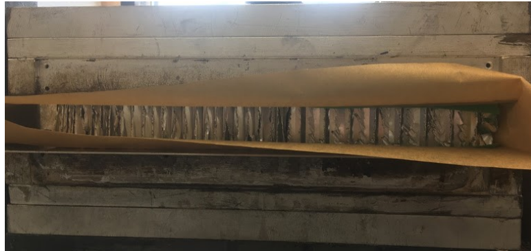
Obr. 43 Detailní pohled na lisování sendviče
