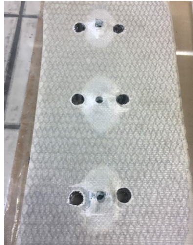
Obr. 62 Sendvič po vytržení insertů
