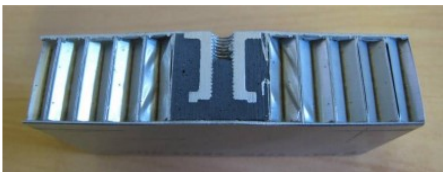
Obr. 17 Řez sendviče s insertem „Cold bonded“ [15]
