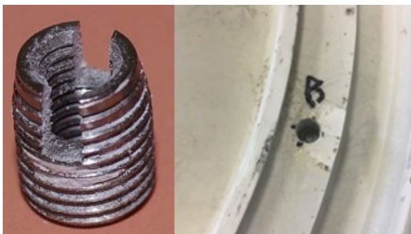
Obr. 53 Insert typu B po vytržení z desky
