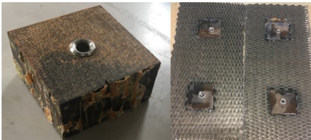
Obr. 39 Uložené kartitové tělesa v hliníkové voštině
