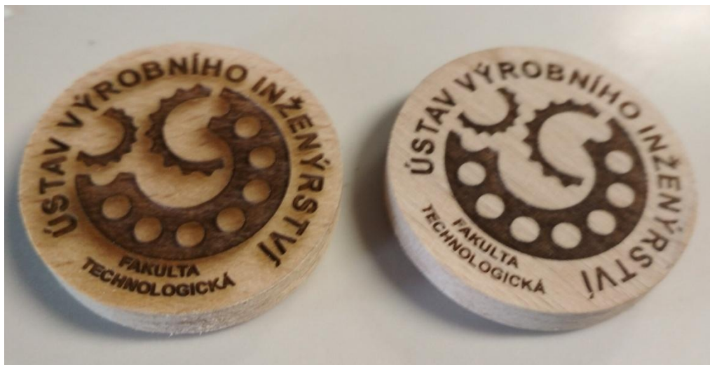
Obr. 48: Dřevěný obrobek před broušením (vlevo) a po broušení (vpravo).
