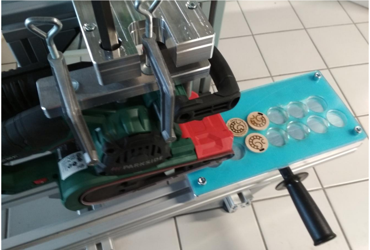
Obr. 47: Zařízení se šablonou pro dřevěné žetony.
