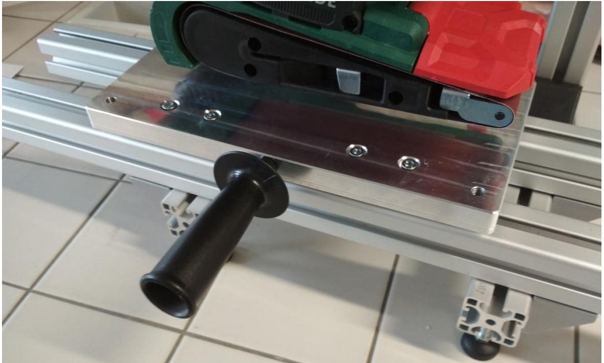
Obr. 46: Rám s nasunutou základní upínací deskou ve vedení a rukojetí.
