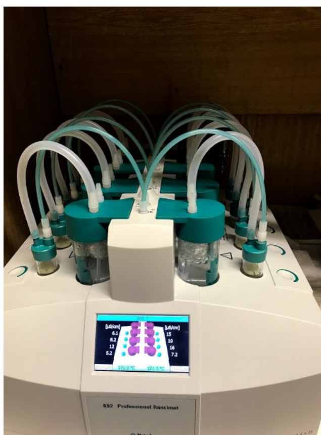
Obr. 11. Přístroj Rancimat Profesional 892 v provozu při měření
