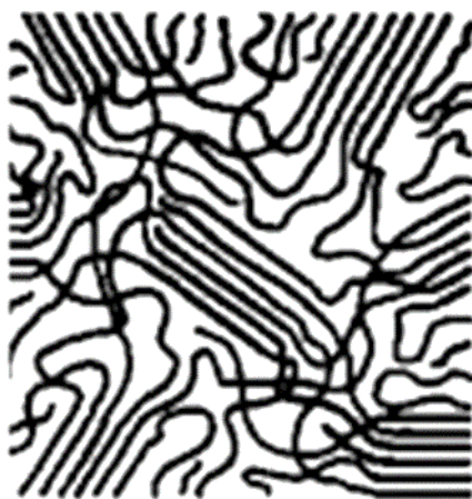
Obr. 2.7: Dvoufázový model semikrystalického polymeru [41].
