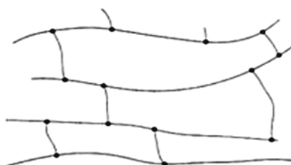
Obr. 2.11: Makromolekulární struktura elastomerů [46].
