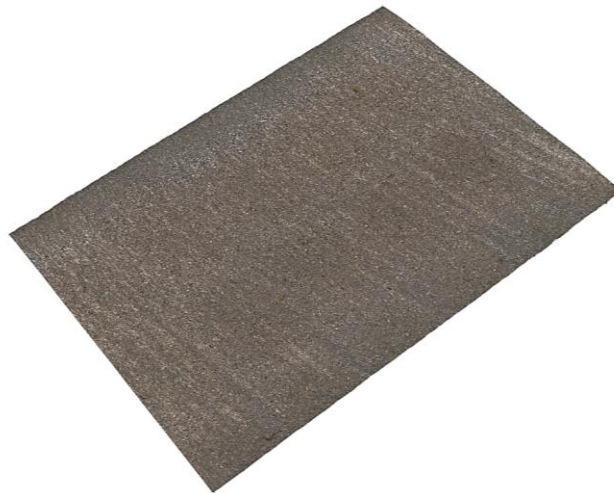
Obr. 104 Textura řezné plochy – ocel 1.4301, TL. 15 mm, řez vodním paprskem
