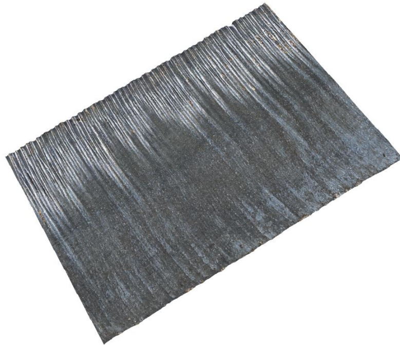
Obr. 90 Textura řezné plochy – ocel 1.7102, TL. 15 mm, řez laserem
