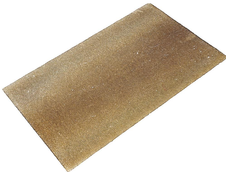
Obr. 94 Textura řezné plochy – ocel 1.7102, TL. 15 mm, elektroer. drátové řezání
