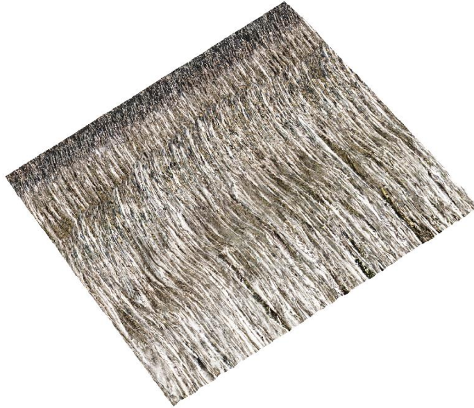
Obr. 98 Textura řezné plochy – ocel 1.4301, TL. 15 mm, řez laserem
