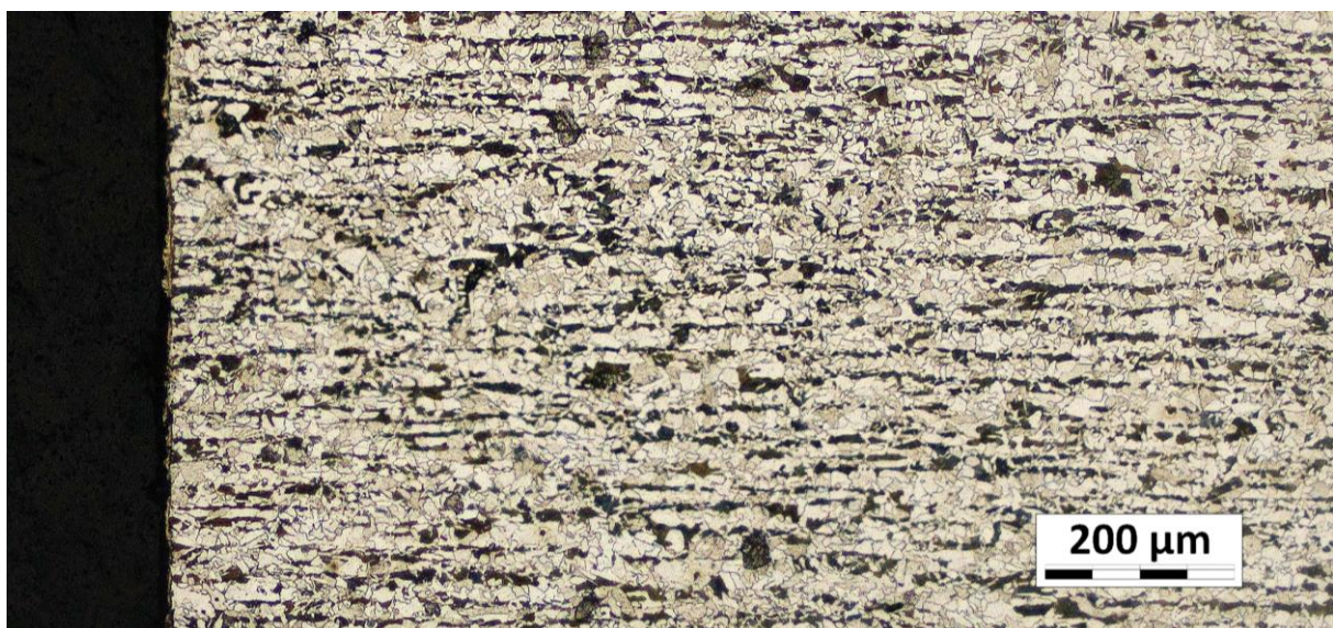
Obr. 47 Struktura oceli 1.0553 v místě řezu po elektroerozivním drátovém řezání
