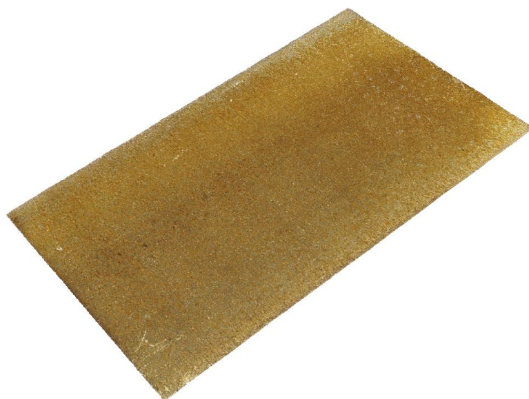
Obr. 86 Textura řezné plochy – ocel 1.0553, TL. 15 mm, elektroer. drátové řezání
