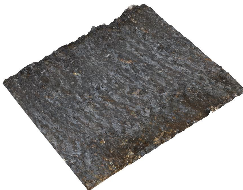
Obr. 100 Textura řezné plochy – ocel 1.4301, TL. 15 mm, řez plazmou
