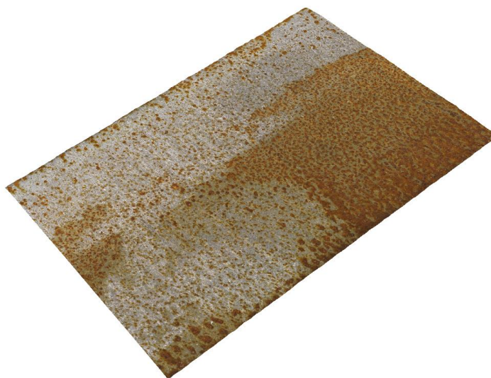
Obr. 88 Textura řezné plochy – ocel 1.0553, TL. 15 mm, řez vodním paprskem
