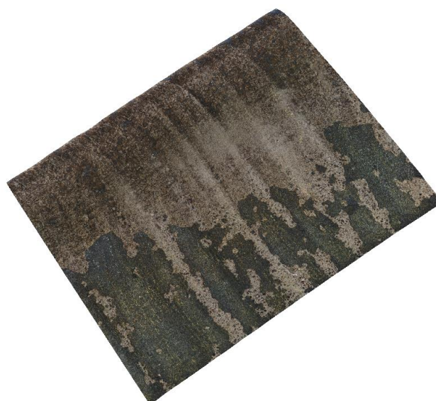
Obr. 84 Textura řezné plochy – ocel 1.0553, TL. 15 mm, řez plazmou
