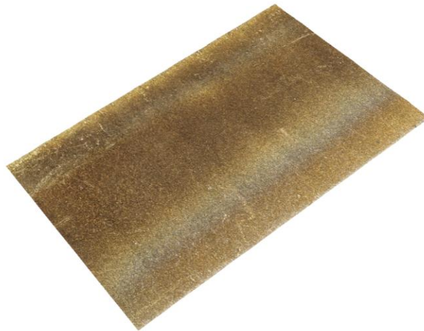
Obr. 102 Textura řezné plochy – ocel 1.4301, TL. 15 mm, elektroer. drátové řezání
