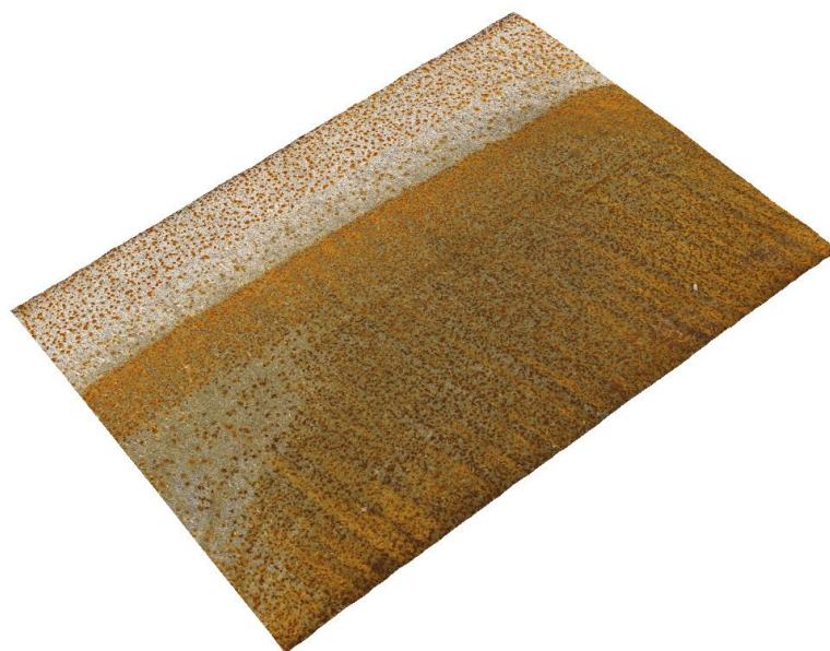
Obr. 96 Textura řezné plochy – ocel 1.7102, TL. 15 mm, řez vodním paprskem
