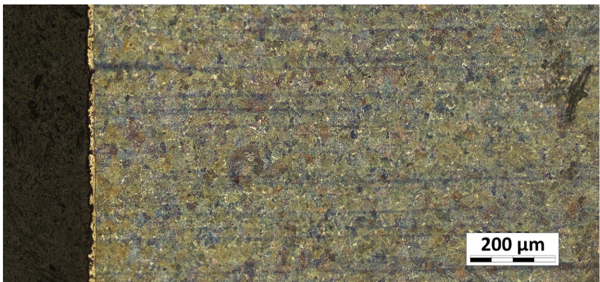
Obr. 55 Struktura oceli 1.7102 v místě řezu po elektroerozivním drátovém řezání
