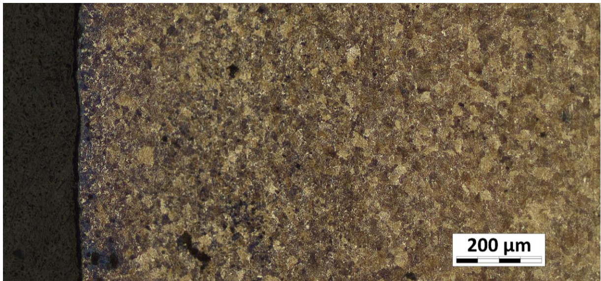
Obr. 57 Struktura oceli 1.7102 v místě řezu po dělení vodním paprskem
