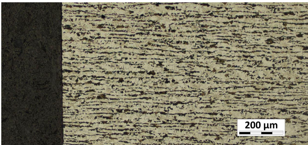
Obr. 49 Struktura oceli 1.0553 v místě řezu po dělení vodním paprskem
