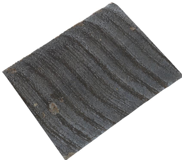
Obr. 92 Textura řezné plochy – ocel 1.7102, TL. 15 mm, řez plazmou
