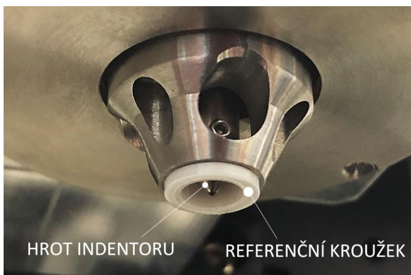
Obr. 37 Konstruktivní řešení vyhledávání povrchu vzorku při měření DSI
