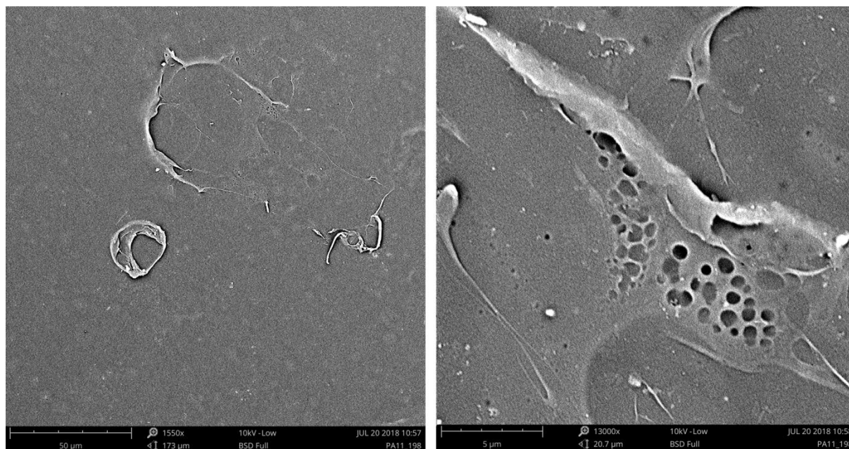
Obr. 79 – SEM povrch PA 6 198 kGy – 1550x, 13000x
