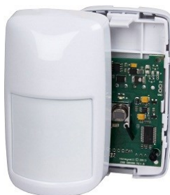
Obrázek 21. PIR detektor Honeywell IS3016 [49]
