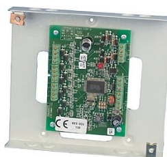
Obrázek 15. Koncentrátor (expandér) – Honeywell G8 [42]
