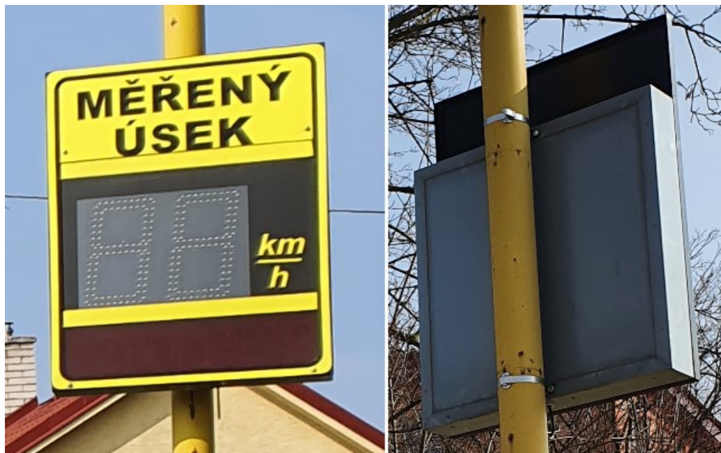
Obrázek 19 – Informativní radarový měřič GEM CDU 2605 DS C30
