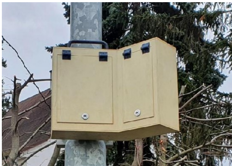
Obrázek 17 – Dopravní sčítač Viacount II použitý v rámci diplomové práce
