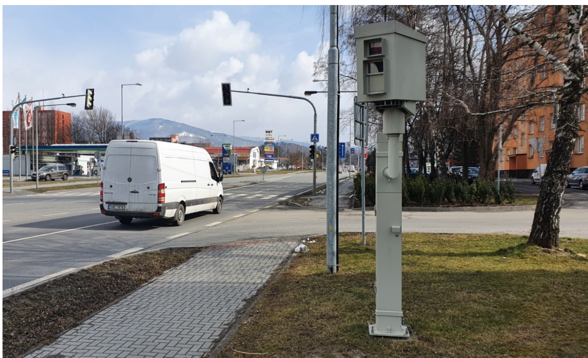
Obrázek 16 – Automatizovaný radarový měřič rychlosti, obec Rožnov pod Radhoštěm
