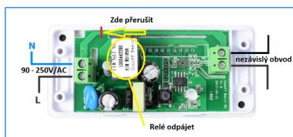
Obr. 42 Úprava modulu basic pro spínání nezávislého obvodu [Zdroj: vlastní]
