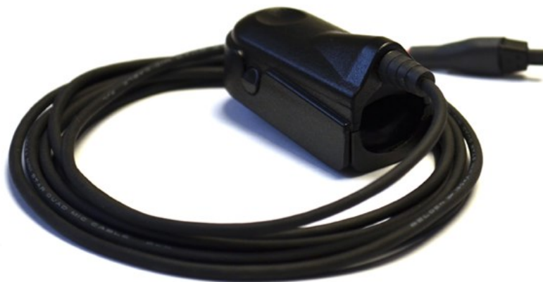
Obrázek 8 – Fotoelektrický prstový pletysmograf [28]
